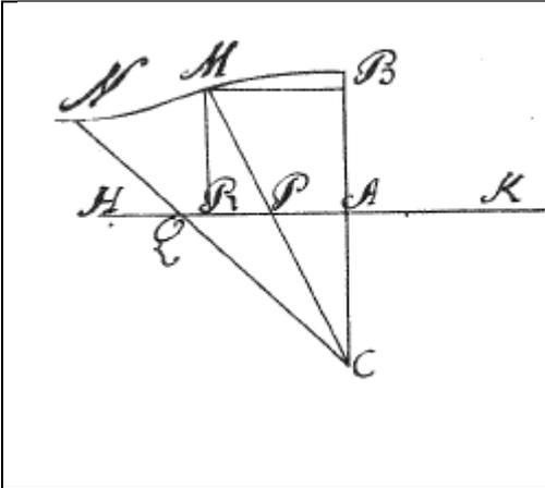
Per ridurre questa curva ad una equazione algebrica tirisi dal punto  $C$  la  $CAB$  perpendicolare ad  $HK$  e da un punto qualunque  $M$  di quei che ad essa Curva appartengono tirinsi le due rette  $MR$  ed  $MB$  parallele alle  $AB$  ed  $AH$  e si tiri  $AR$  per una ascissa  $x$  ed  $MR$  per l'ordinata corrispondente  $y$ . Chiamisi inoltre la distanza  $CA = a$  la lunghezza costante  $MP = b$ , e ne' triangoli simili  $RMP, MBC$  si aurà
